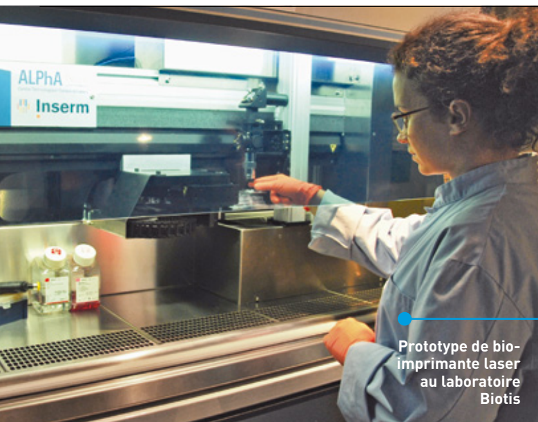
Vérification de l'impression par laser et de l'évolution quotidienne des cellules vivantes (lignes de gouttes de cellules de mélanome) sur des lames
