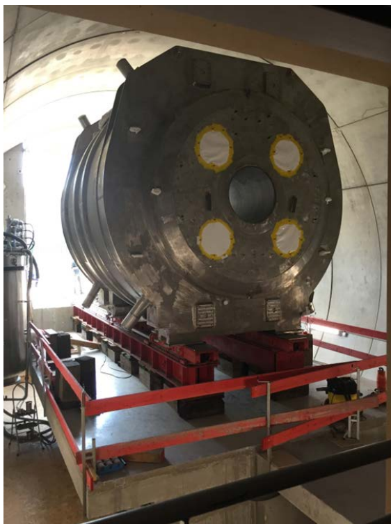
Figure 2. Aimant 11,7 teslas du projet Iseult dans son arche © Neurospin
