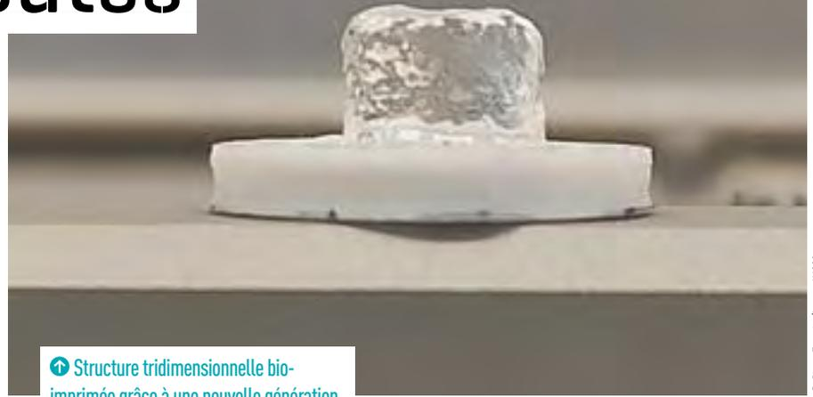
Structure tridimensionnelle bio-imprimée grâce à une nouvelle génération d'hydrogel imprimable
