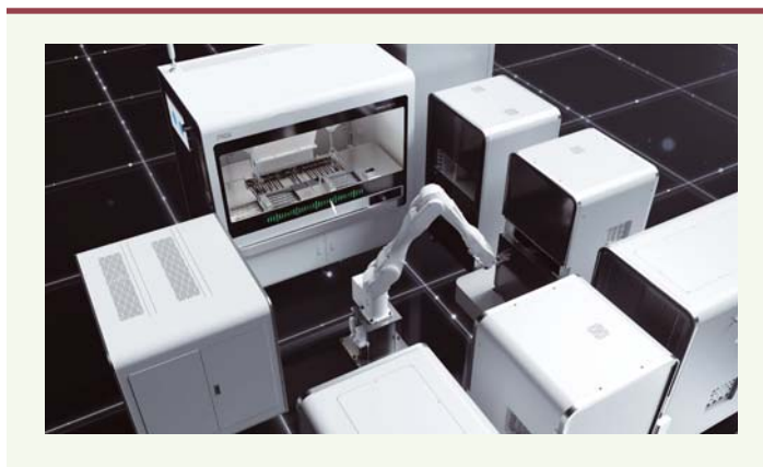
Figure 2. Du très haut de gamme : le système « DNBSEQ-T10x4RS » proposé par MGI/Complete Genomics , qui rassemble plusieurs appareils servis par un bras robotique et pour lequel l'entreprise revendique une production de 76 térabases (de séquence brute) en une session de quatre jours environ. Extrait du site de MGI-Tech ( https://en.mgi-tech.com/products/ ).
