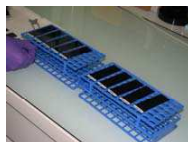
Puces à ADN sur un portoir (séchage après hybridation)
