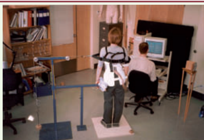
Figure 4. Montage expérimental pour tester l'effet « actif » ou « passif » des corsets TLS.
